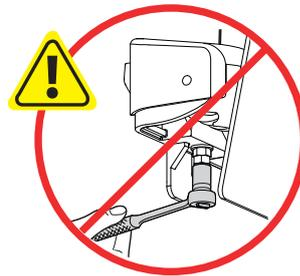
**ATTENTION !** L'écrou du bas tournera pendant l'ajustement de celui du haut ; n'utilisez AUCUN outil sur l'écrou du bas. De graves dommages pourraient survenir dans le cas où ces instructions ne seraient pas suivies.
